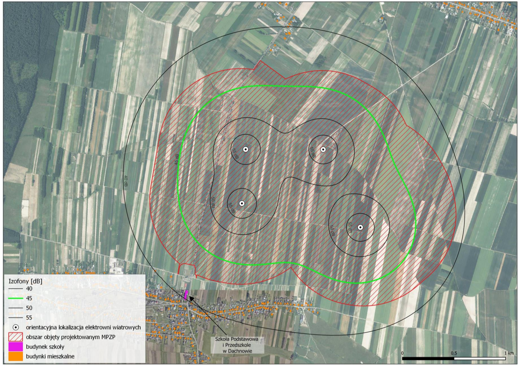
Ryc. 3. Mapa akustyczna – rozkład izofon wokół planowanych elektrowni wiatrowych
